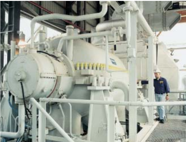
Propane Compressor for Qatar LNG Plant
